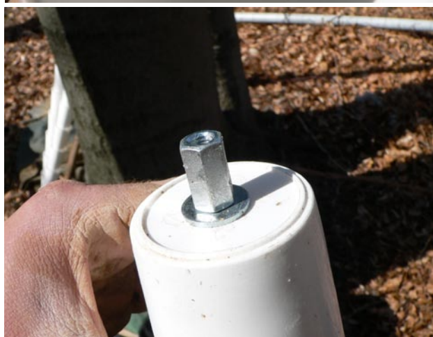
Obr. 2. Detail kelímku podzemní padací pasti. Nahoře: závitová tyč uvnitř kelímku. Dole: matka pod kelímek, do níž se zašroubuje závitová tyč dalšího kelímku. Foto: Ivan H. Tuf.
