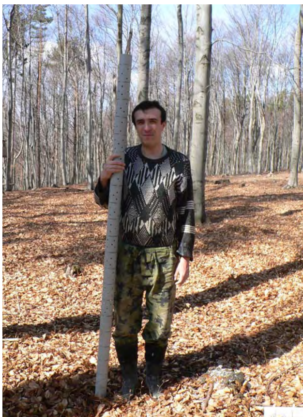
Obr. 1. Perforovaná plastová trubka coby součást podzemní padací pasti, vyfoceno na zkoumané lokalitě. Foto: Ivan H. Tuf.
